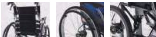
バックインナーサポート・座インナーシート 軽量ハイポリマータイヤ(黒) SKブレーキ
