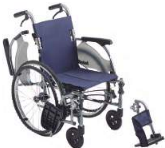
新ハイパーXフレーム ワンハンドブレーキ(特許出願済) 車椅子の心臓部である 左右いずれかの一方のレバーを引く ことで、両輪の駐車ブレーキをかけ ることができます。また、伸縮延長 レバーを伸ばすと軽い力でブレーキ を操作することができます。
